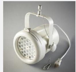
SL2は、天井高4~7mの会場に最適なハロゲン500W相当のあかりを消費電力64W(ハロゲンランプの約1/8)の省エネ設計で実現。3種類のレンズラインナップ(ナロー13°/ミディアム20°/ワイド30°)に加え、LSDフィルターとカラー・フィルターをダブルで装着でき、フィルター装着部の120度回転を可能としたモデルです。
